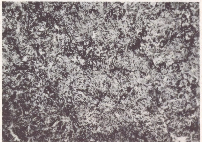
Abb. 7 Gefüge im Bereich der Schneidenspitze aus Abb. 5, Sekundärätzung, 250-fache Vergr.
