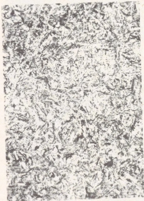
Abb. 20 Gefüge im Bereich der Säbelschneide, Sekundärätzung mit alkoholischer Salpetersäure, 250-fache Vergr.
