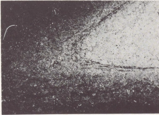
Abb. 6 Übergangsgefüge Weich- eisen-Stahl aus Abb. 5, Sekundärätzung, 50-fache Vergr.
